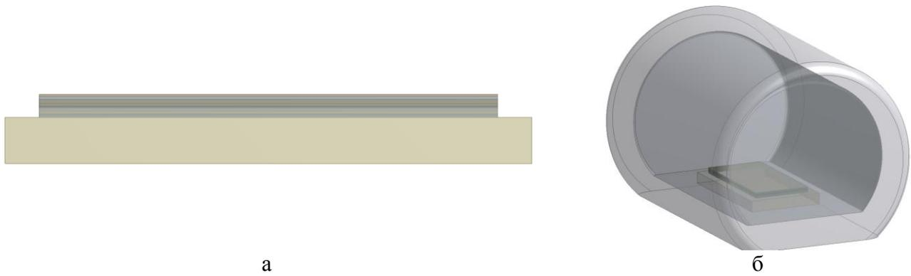
Рисунок 2 – Геометрическая модель, где: а – пакет из КМ на пластине; б – пакет из КМ на пластине в печи
